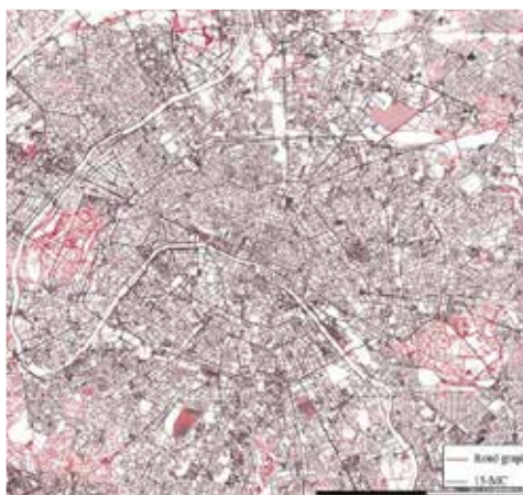
Figura 4: applicazione del metodo alla mappa di Parigi. L'elaborazione evidenzia, in rosso, il grafo urbano delle zone di città 'non 15M' e, in nero, quelle '15M'.
